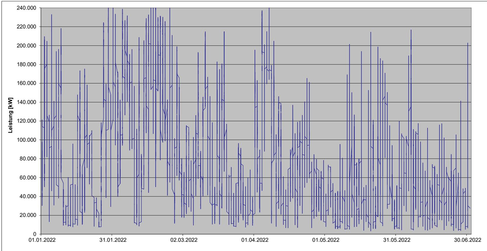
**Lastverlauf der Einspeisungen in die Mittelspannungsebene der NEW Netz GmbH im Jahr 2022 (2. Halbjahr)**
