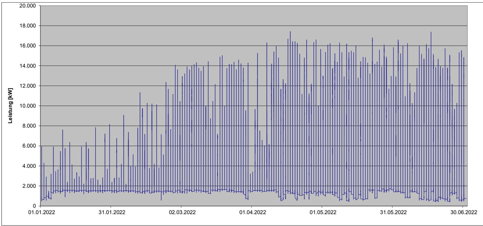
Lastverlauf der Einspeisungen in die Umspannung MS/NS der NEW Netz GmbH im Jahr 2022 (2. Halbjahr)
