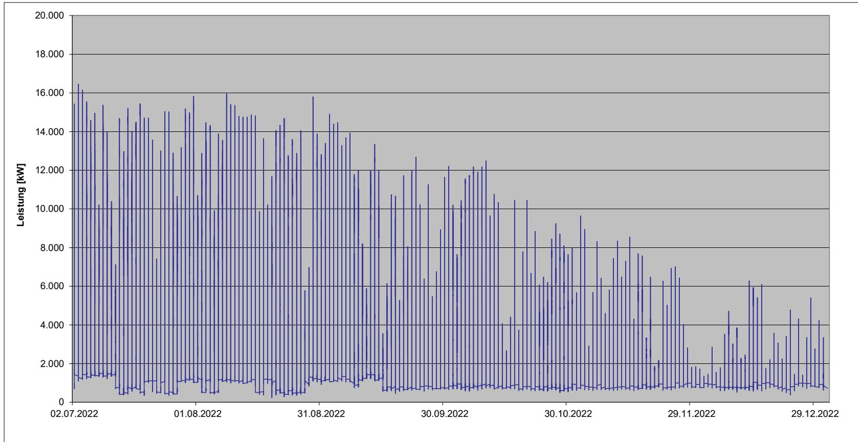
Lastverlauf der Einspeisungen in die Niederspannungsebene der NEW Netz GmbH im Jahr 2022 (1. Halbjahr)
