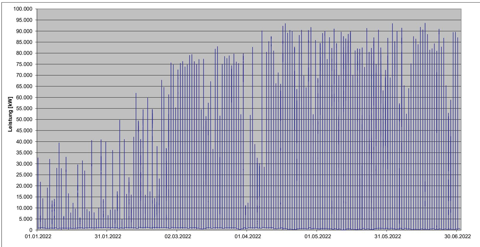
Lastverlauf der Einspeisungen in die Niederspannungsebene der NEW Netz GmbH im Jahr 2022 (2. Halbjahr)
