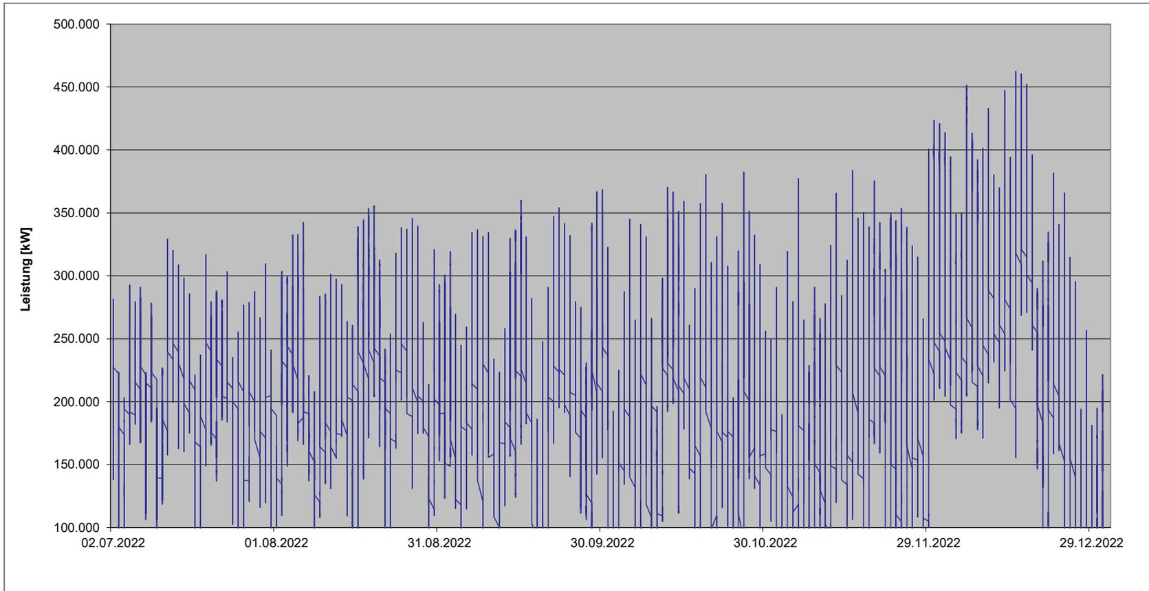
Lastverlauf der Einspeisungen in die Mittelspannungsebene der NEW Netz GmbH im Jahr 2022 (1. Halbjahr)
