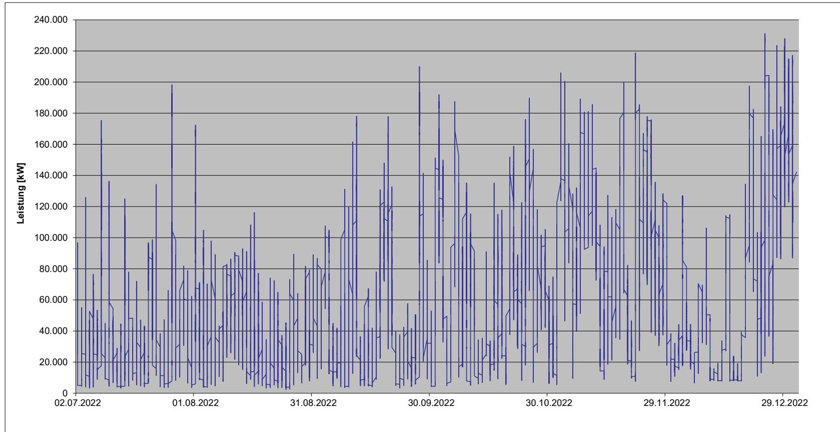
Lastverlauf der Einspeisungen in die Umspannung MS/NS der NEW Netz GmbH im Jahr 222 (1. Halbjahr)
